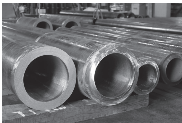
▲開先加工済みのパイプ
